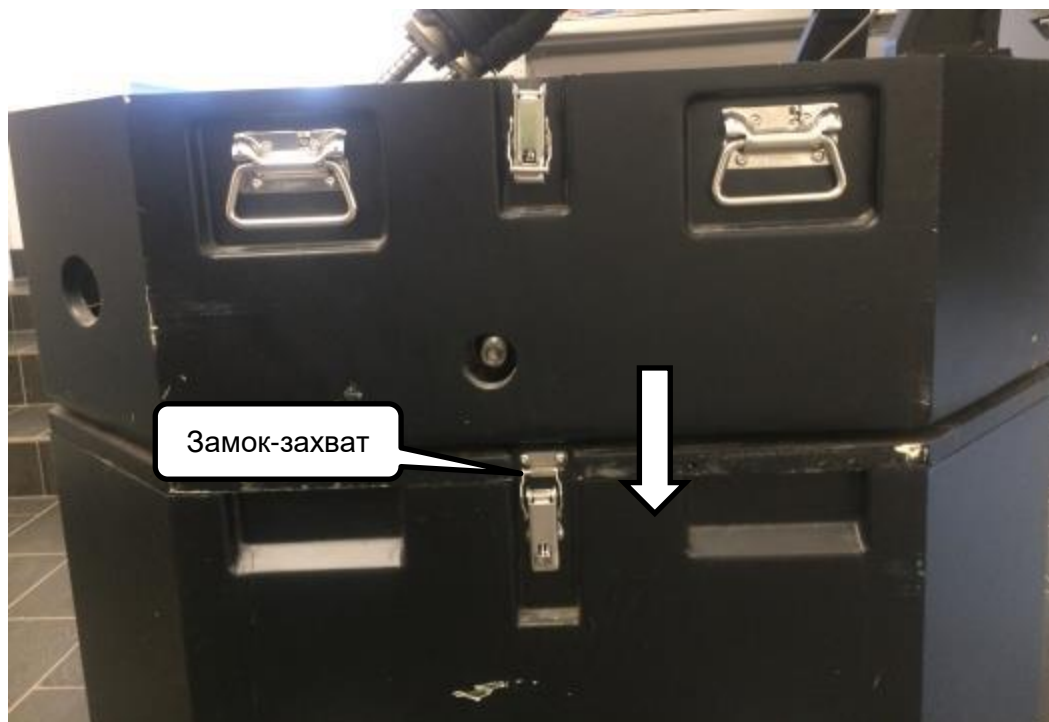
Рисунок 2.2.1.4.1 – Установка кейсов АП
