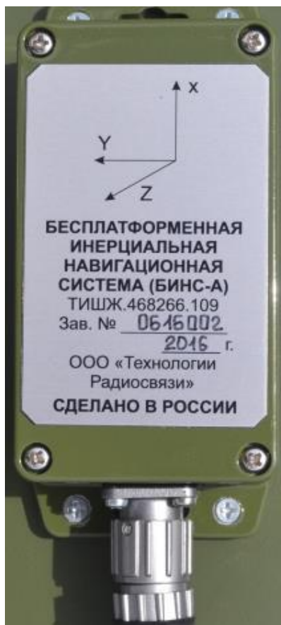
Рисунок 1.2.2.1 – Внешний вид БИНС-А ТИШЖ.468266.109
